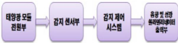
[그림 3] 무인 감시 장치 시스템의 구성도
